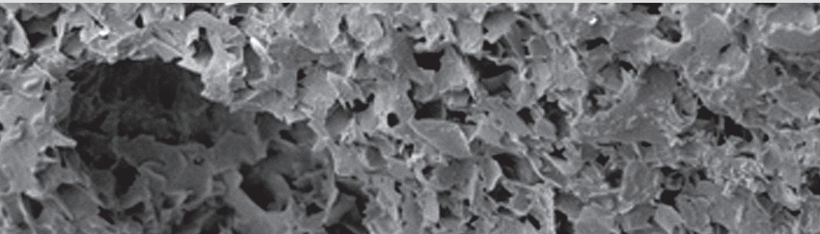
Mikroporen in Kombination mit „schweren“ Anteilen sorgen für schalldämpfende und feuchtigkeitsregulierende Eigenschaften
